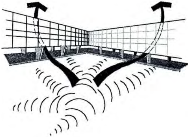
شکل ۲-۲۱-۵- تخلیه موج انفجار از پیلوت باز
